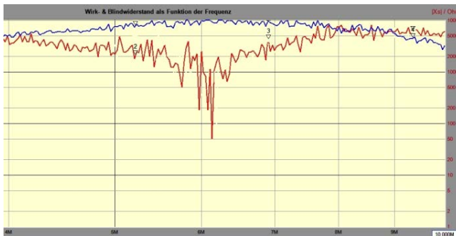
Pollin-Kern 2: NZ-Ferrit Chilisin BRH 28,5x28,5x14 mit 4 + 1 + 4 Windungen
