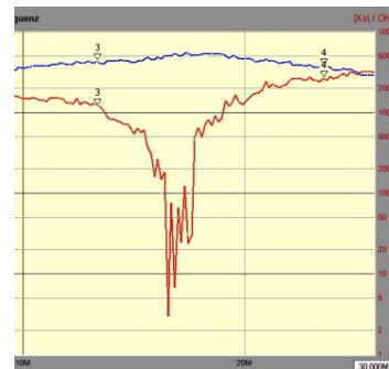
Amidon-Kern 3: FT140-43 mit 5 + 1 + 5 Windungen
